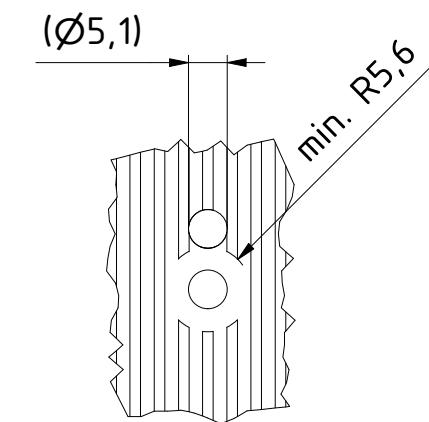
In diesem Bereich sind die Führungsrippen des Seitenprofiles von innen entfernt
