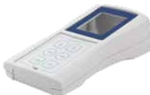
За счет поворота верхней части на 180° относительно нижней части можно легко получить пультовой вариант.
