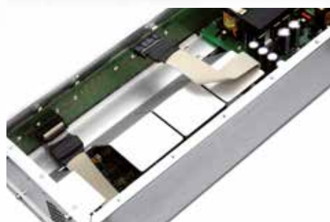
Теплопроводящий лист, изготовленный из алюминия
