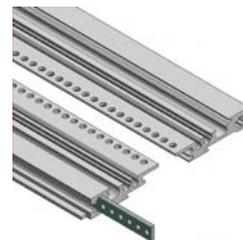
Планки с резьбовыми отверстиями, M2,5, 5 x 1,5 мм, для горизонтальных пазов профиля и для крепления с задней стороны IS ZS или плат шины
