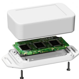
Печатная плата толщиной 1,6 мм может быть зажата непосредственно между двумя частями корпуса и опционально закреплена при помощи двух оплавляемых штифтов
